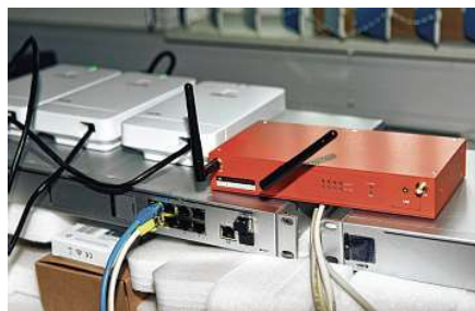
In der Informationstechnik unerlässlich: Eine Firewall, die als Sicherheitsvorrichtung den Datenverkehr überwacht und unerwünschte sowie gefährliche Verbindungen blockiert, und somit das Netzwerk vor Angriffen und Bedrohungen schützt – es sicher macht.
